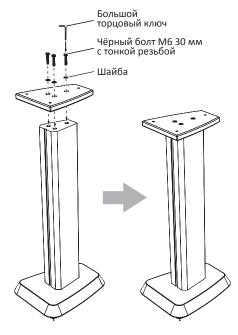
4. Прикрепите колонку к опоре, как показано на рисунке внизу. К М-опоре можно прикрепить только колонки модели "Revel Performa3" M106 и M105. Свяжите провода в пучок при помощи ремня VELCRO®.
