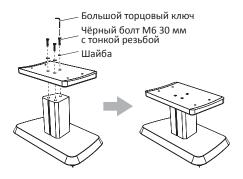
4. Прикрепите колонку к опоре, как показано на рисунке внизу. К М-опоре можно прикрепить только колонки модели "Revel Performa3" C208 и C205.
