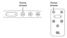
Если не нажимать кнопку питания, звуковая панель автоматически перейдет в режим ожидания приблизительно через 10 минут после прекращения подачи аудиосигнала. ПРИМЕЧАНИЕ. При переводе звуковой панели в режим ожидания нажатием кнопки питания следует вручную включить ее, снова нажав кнопку питания. Если звуковая панель переходит в режим ожидания автоматически через 10 минут после прекращения подачи аудиосигнала, она автоматически включится, получив аудиосигнал на любой из входных разъемов.
