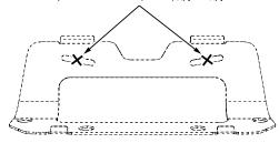
Используя инструменты и фурнитуру, подходящие для материала и конструкции стены, прикрепите кронштейн к стене в отмеченном месте. Помните, что вес звуковой панели составляет 2,5 кг (5,5 фунта). Используйте фурнитуру, которая может выдержать этот вес.
