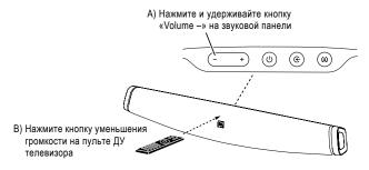
Нажмите кнопку выключения звука на пульте ДУ телевизора, удерживая нажатыми одновременно кнопки увеличения и уменьшения громкости («Volume +» и «Volume –») звуковой панели. Если программирование было успешным, кнопка выбора режима пространственного звука на звуковой панели на одну секунду изменит цвет с желтого на сплошной белый, после чего снова начнет мигать желтым цветом.
