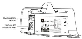
Выходной разъем сабвуфера: при использовании активного сабвуфера (не входит в комплект) со звуковой панелью подключите его здесь. Примечание. С этого разъема через фильтр выходит низкочастотный сигнал, поэтому его нужно подключать к входу сабвуфера, который минует его встроенный кроссовер. Обратитесь к руководству пользователя сабвуфера для получения инструкций о его подключении и настройке.
